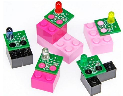
Abb. 1-27 Bestückte Elektor-Legoled-Platine an LEGO-Steinen
