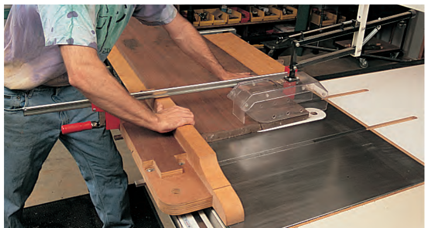
Die Tischkreissäge ist die wichtigste Maschine in jeder Tischlerwerkstatt. Man kann ihre Einsatzfähigkeit durch einen schweren Ablängschlitten erhöhen, der auch breite oder lange Bretter aufnehmen kann.
