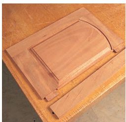
144 Türen aus Rahmen und Füllung
