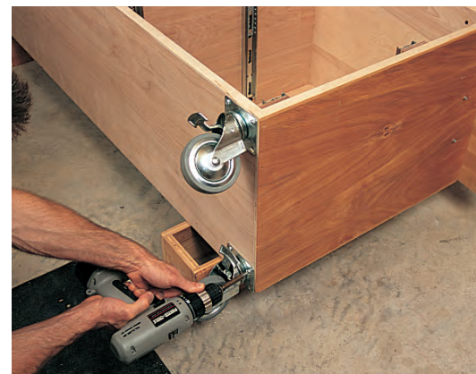
Ein Untersatz mit Rollen erlaubt es, auch schwere Maschinen und Zubehörteile einfach zu bewegen.
