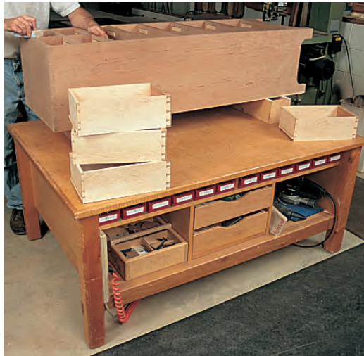
Ein niedriger Tisch für Montage-, Einspann- und Schleifarbeiten kann einem Rückenschmerzen ersparen.
