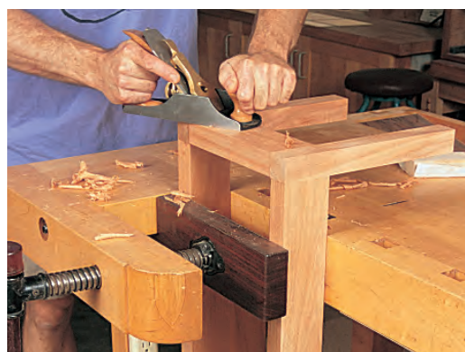
In der Vorderzange können größere Werkstücke als Ganzes leicht eingespannt werden. Dieses Exemplar hat eine schwenkbare Einlage, um auch auf Werkstücke mit Verjüngungen gleichmäßigen Druck ausüben zu können.
