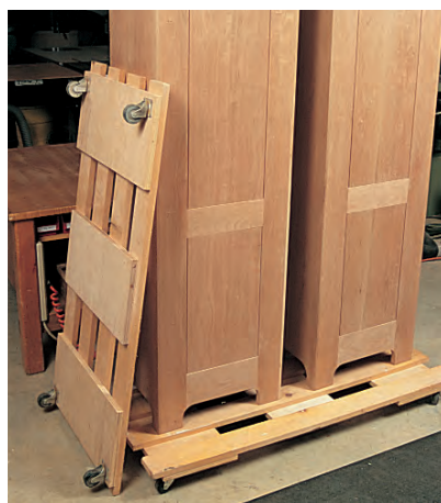
Selbst hergestellte Transportwagen tragen dazu bei, Werkstücke sicher aufzubewahren, da man sie so leicht aus eventuellen Gefahrenzonen fortschaffen kann.
