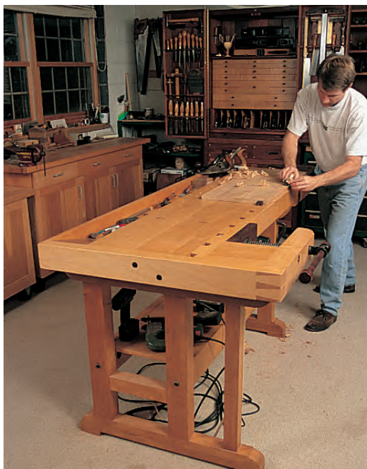
Wenn man das Werkstück zwischen Bankhaken einspannt, liegt es eben auf der Hobelbank auf, was besonders bei der Arbeit mit dem Hobel nützlich ist.
