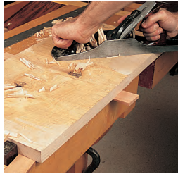
27 Ein Brett mit Handwerkzeug abrichten
