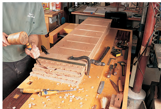
Ein Niederhalter wird in der Hobelbank verkeilt, um das Werkstück für Handarbeit – besonders mit dem Schnitzzeisen oder Stechbeitel – zu fixieren.
