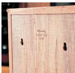
57 Befestigung an der Wand
