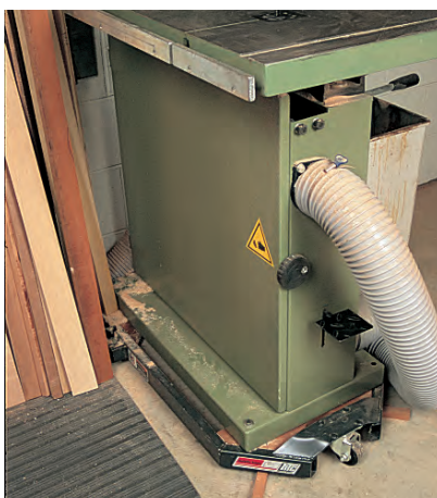
Ein Untersatz mit Rollen erlaubt es, auch schwere Maschinen und Zubehörteile einfach zu bewegen.
