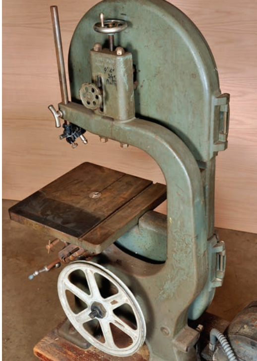
Mit Rollengehäusen und Gestell aus Gusseisen ist diese alte Bandsäge von Walker-Turner eine schwere und leistungsfähige Maschine.
