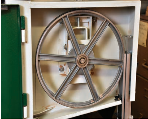
Leichten Rollen aus Aluminiumdruckguss fehlt die träge Masse der schwereren Rollen, aber sie erreichen ihre Höchstgeschwindigkeit schneller, ein Vorteil von kleineren Sägen.
