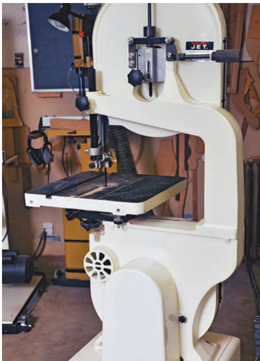
Mit Rollengehäusen und Gestell aus Gusseisen ist diese alte Bandsäge von Walker-Turner eine schwere und leistungsfähige Maschine.
