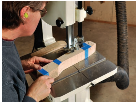
Zu den einzigartigen Fähigkeiten der Bandsäge gehört das Sägen von komplizierten Formen und zusammengesetzten Kurven.
