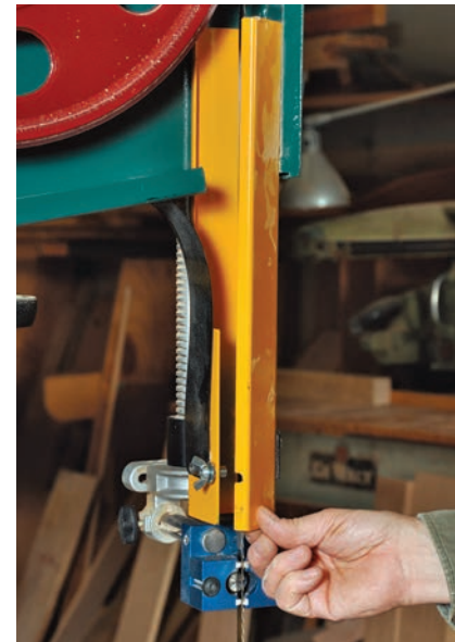
Der Blattschutz an dieser Bandsäge weist eine Klappe mit Scharnieren auf, durch die man Zugang zum Sägeblatt hat.
