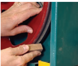
50 Instandsetzung der Rollen
