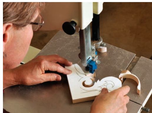
Mit einem schmalen Schweißband versehen, kann eine Bandsäge auch präzise Kreise und enge Radien schneiden, bei denen der Schnitt senkrecht zur Holzoberfläche steht.
