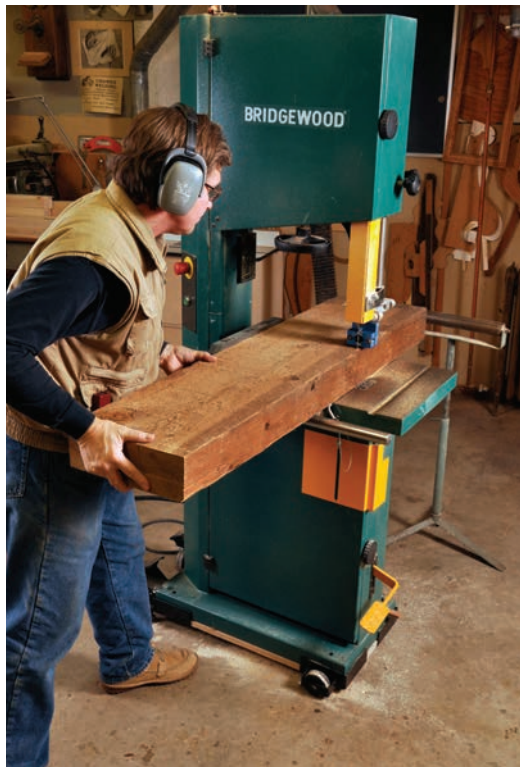
Auch mit einem 220-Volt-Gleichstrommotor kann eine Bandsäge starke Holzquerschnitte bewältigen.
