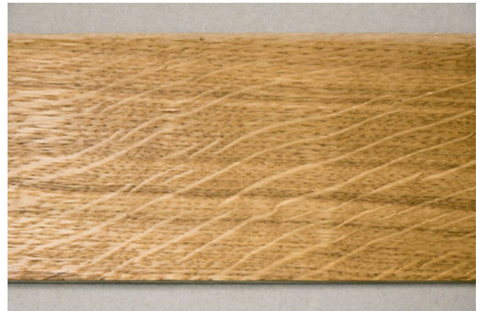
Auf einem Eichenbrett sind diese Markstrahlen als helle „Spiegel“ zu erkennen, die in der Regel Oberflächenmittel schlechter annehmen als das übrige Eichenholz.
