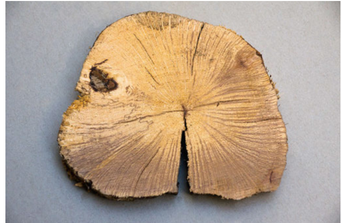
Dieser Stammquerschnitt aus Eichenholz zeigt eine deutliche radiale Faserstruktur. Die hellen Streifen sind die für Eiche besonders typischen Markstrahlen, die für eine zusätzliche Nährstoffversorgung des Stammes von der Rinde bis zu Kern sorgen.
