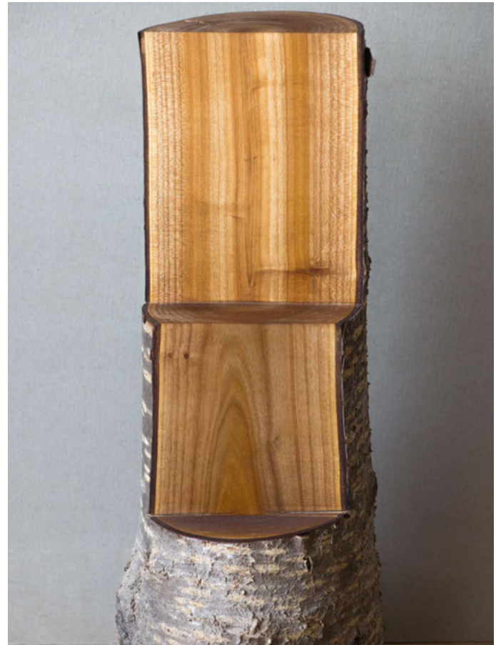
Die Faserrichtung des aufgeschnittenen Kirschbaumstammes verläuft im Kernbereich parallel zum Schnitt. Beim ebenfalls senkrecht geschnittenen Seitenbrett ist eine deutliche Fladerung zu erkennen, die durch die schräg angeschnittenen Holzfasern entsteht. Die wiederum hängt mit der Verjüngung des Stammes von unten nach oben zusammen.
