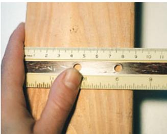
**Abbildung 1.2** Messung der Breite eines Holzbretts mit dem Zentimetermaß. Die Genauigkeit beträgt  $\pm 1$  mm.
