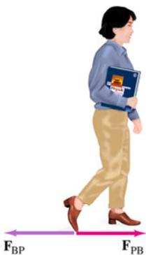
**Abbildung 4.11** Das dritte Newton'sche Axiom. Tiefgestellte Indizes an den Vektorsymbolen der Kräfte zeigen uns, auf welchen Körper eine Kraft wirkt und von welchem Körper sie ausgeübt wird.
