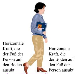
**Abbildung 4.10** Wir können vorwärts gehen, weil, wenn ein Fuß nach hinten gegen den Boden drückt, der Boden diesen Fuß nach vorn schiebt. Die beiden dargestellten Kräfte wirken auf verschiedene Körper.
