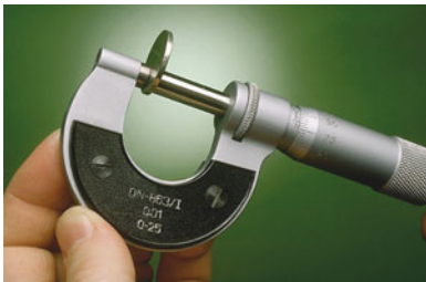
Abbildung 1.6 Eine Mikrometerschraube dient der Messung kleiner Dicken.
