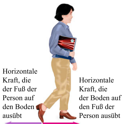
Abbildung 4.11 Wir können vorwärtsgehen, weil, wenn ein Fuß nach hinten gegen den Boden drückt, der Boden diesen Fuß nach vorn schiebt. Die beiden dargestellten Kräfte wirken auf verschiedene Körper .
