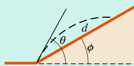
Abbildung 3.48 Aufgabe 49. Gegeben sind \phi und v_0 , bestimmen Sie \theta , so dass d möglichst groß ist.
