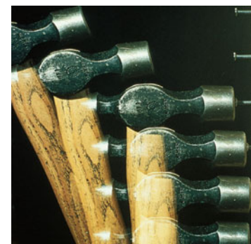
Abbildung 4.8 Mehrfach belichtete Aufnahme eines Hammers, der auf einen Nagel schlägt. Nach dem dritten Newton'schen Axiom übt der Hammer eine Kraft auf den Nagel aus und der Nagel wiederum eine Kraft auf den Hammer. Letztere bremst den Hammer ab und bringt ihn zum Stillstand.
