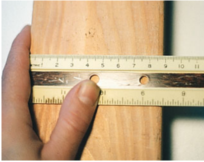
Abbildung 1.2 Messung der Breite eines Holzbretts mit dem Zentimetermaß. Die Genauigkeit beträgt \pm 1 mm.
