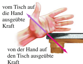
Abbildung 4.9 Wenn Ihre Hand gegen die Kante eines Tisches drückt (der Kraftvektor ist in rot dargestellt), drückt auch der Tisch wieder gegen Ihre Hand (dieser Kraftvektor ist in violett dargestellt, um zu verdeutlichen, dass diese Kraft auf einen anderen Körper wirkt).
