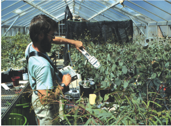
Abbildung 1.8: Diese Eucalyptus -Jungpflanzen werden in einem Gewächshaus für ein Experiment gezogen, bei dem die Reaktionen der Pflanzen auf unterschiedliche Nährstoffgaben untersucht werden sollen. Der Wissenschaftler auf dem Bild verwendet ein tragbares Instrument zur Messung der Photosyntheserate von Pflanzen, die im Laufe ihres Wachstums unterschiedliche Stickstoffmengen bekommen haben.
