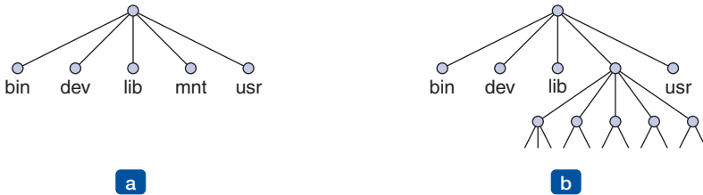
Abbildung 1.22: Dateisystem vor dem Aufruf von mount ; (b) Dateisystem nach dem mount -Aufruf.
