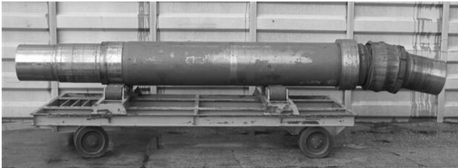
Abbildung 1.10: Plastische Verformung eines Wellenzapfens einer Förderbandtrommel [1.48]
