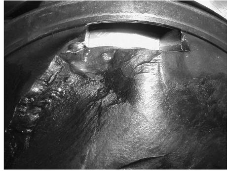
Abbildung 1.7: Dauerbruch einer Welle aus einer Presse (links) und einer Windenergie-Anlage (rechts) durch Biegebelastung [1.30], [1.44]
