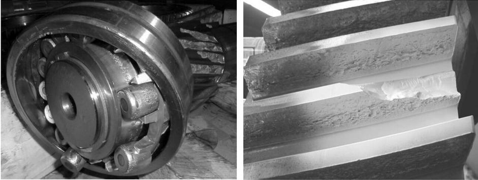
Abbildung 1.9: Ermüdungsschaden an den Wälzkörpern und der Laufbahn eines Wälzlagers (links) und Grübchenbildung an den Zahnflanken eines schräg verzahnten Großrades eines Schaufelradgetriebes (rechts), zusätzlich ist auch noch ein Zahnbruch (Flankenbruch) aufgetreten [1.47]
