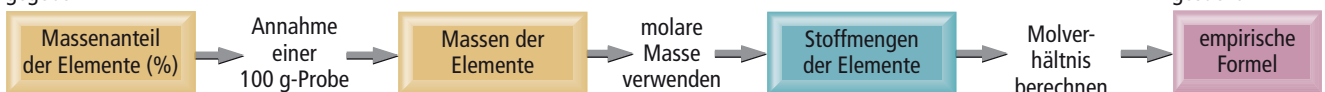
Abbildung 3.8: Vorgehensweise bei der Berechnung einer empirischen Formel aus der prozentualen Zusammensetzung. Der zentrale Bestandteil der Berechnung besteht in der Bestimmung der Stoffmengen der in der Verbindung enthaltenen Elemente.
