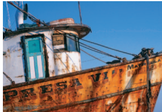
Abbildung 4.9: Korrosion von Eisen. Die Korrosion von Eisen wird durch den chemischen Angriff von Sauerstoff und Wasser auf die ungeschützte Metalloberfläche verursacht. Korrosion wird durch Salzwasser verstärkt.
