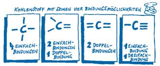
Vierfachbindungen existieren nicht, weil sich die vier Elektronenorbitale aus räumlichen Gründen nicht zu einem einzigen Partner hin orientieren können. Bei einer Vierfachbindung müsste das vierte Bindungselektron durch den Atomkern wirken und das ist einfach unmöglich.
