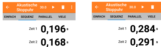
Abbildung 1.15 Links: Zeitdifferenzen zwischen den Aufschlägen bei Objektabständen von 120 cm, rechts: Zeitdifferenzen zwischen den Aufschlägen bei Objektabständen 0, 40, 160, 360 cm vom unteren Objekt
