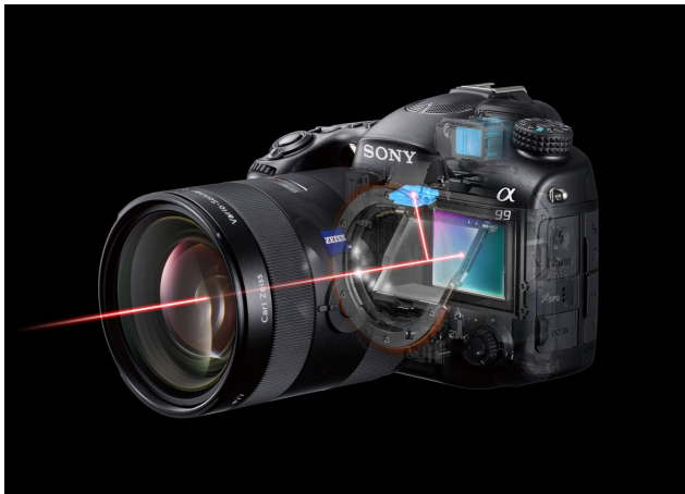
^ Über einen feststehenden, teillichtdurchlässigen Spiegel gelangt Licht auch ohne Hochklappen des Spiegels auf den Sensor und ermöglicht so eine besonders hohe Serienbildgeschwindigkeit. (Bild: Sony)
