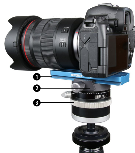
↑ Reverser Kugelkopf der P-Serie von Arca-Swiss, von uns etwas umgebaut mit einer Schwalbenschwanzkupplung (Novoflex Q=Mount) ② und Wechselplatte (Novoflex QPL 3) ①. Hier liegt der Kugelkopf unten, und die Friktion wird über einen Feststeller ③ reguliert.
