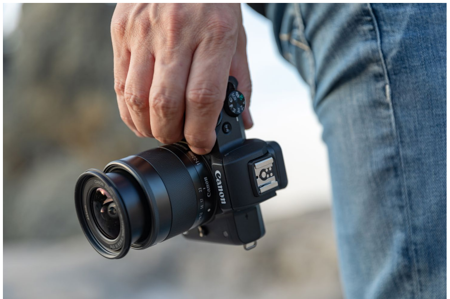
↑ Spiegellose Systemkamera Canon EOS M50, ein handliches Mittelklassemodell mit APS-C-Sensor
