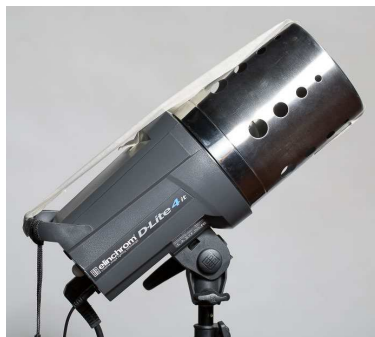
Hier sehen Sie, dass dieser Besteckabtropfkorb denselben Durchmesser hatte wie der Blitzkopf. Ich konnte ihn daher mit Klebeband am Blitzkopf befestigen und als Effekt-Lichtformer einsetzen.
