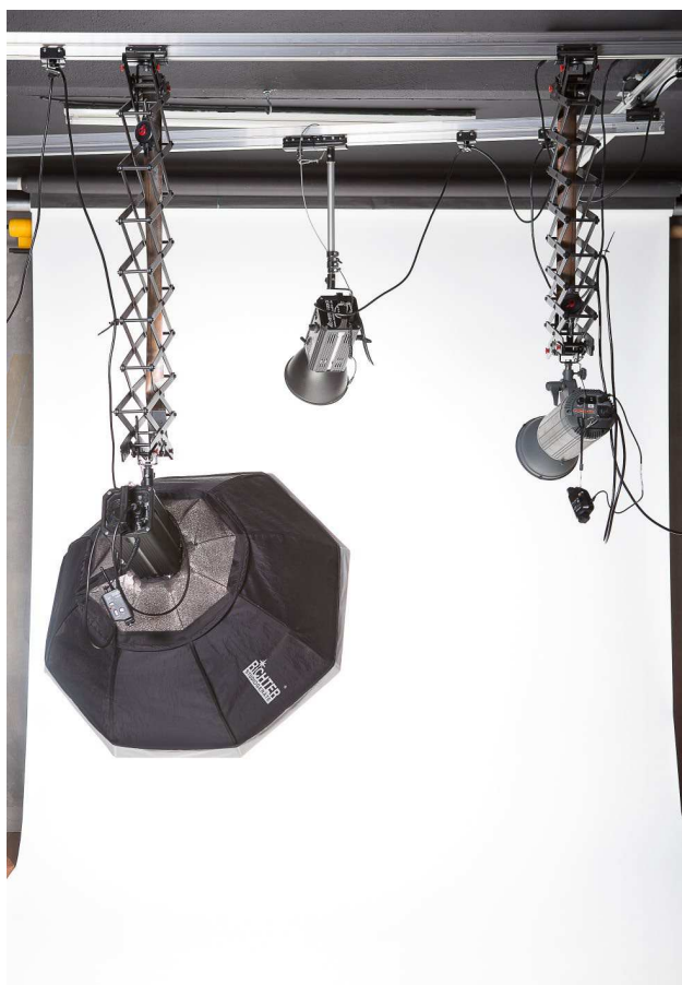
Bei einem solchen Deckenschienensystem können Sie die Höhe der Blitzköpfe einfach verändern, indem Sie an den Kompaktblitzköpfen ziehen bzw. sie nach oben schieben.
