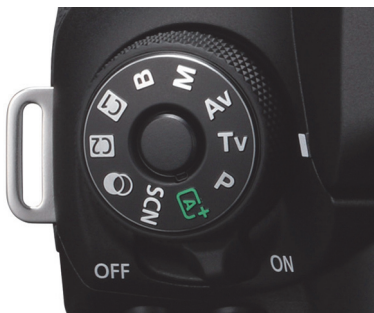
Abbildung 1.5 Das Moduswahlrad ist die Programmschaltzentrale der EOS 90D.
