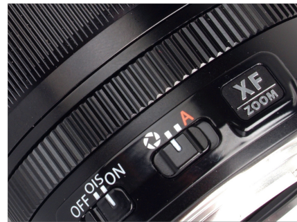
Abbildung 1.8 Zoomobjektive, die keine durchgehend gleiche Lichtstärke haben, haben keine Blendenwerte am Blendenring. Sie können die Blende mit dem Ring einstellen, sehen Ihre Wahl aber nur im Sucher oder im Display. Für die manuelle oder automatische Blende gibt es bei solchen Objektiven einen Schalter. (Bild: Fujifilm)
