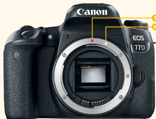
▲ Abbildung 1.20 EF-S-Objektive für Kameras mit APS-C-Sensor (wie die EOS 77D) werden an der weißen Markierung angesetzt (6). Der rote Punkt (5) ist für EF-Objektive, die auch an Vollformatkameras funktionieren.
