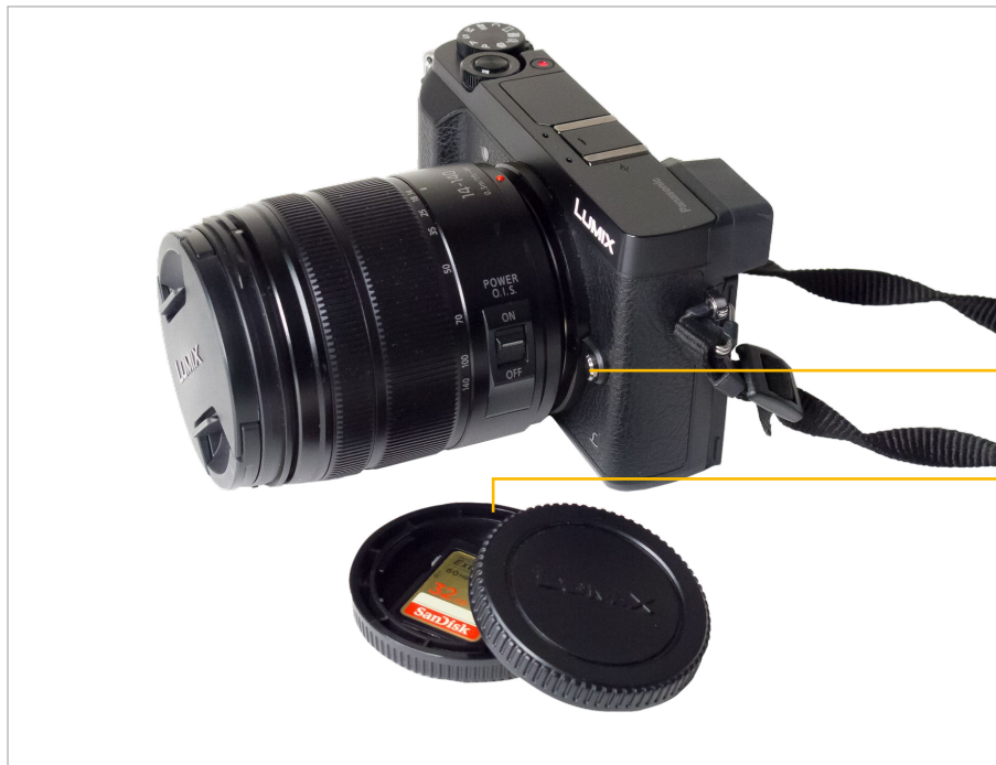
< Abbildung 1.9 Wenn das Objektiv am Gehäuse befestigt ist, befindet sich die rote Markierung oben. Drücken Sie die Entriegelungstaste 3 nur, wenn Sie das Objektiv entfernen wollen.
