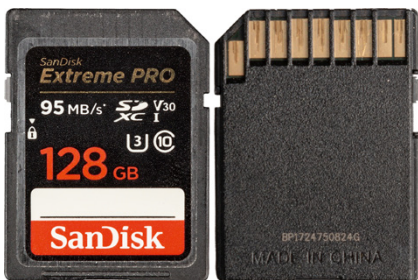
▲ SD-Karten des Standards UHS-I haben auf der Rückseite eine Reihe mit Kontakten.
