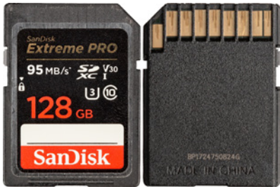
▲ SDXC-Karte mit 128 GB Volumen, UHS-I, Speed Class U3, Video Class V30.
