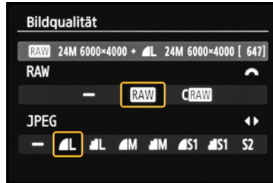
▲ Mit der Q/SET-Taste geöffneter funktionsspezifischer Einstellungsbildschirm der Bildqualität.
