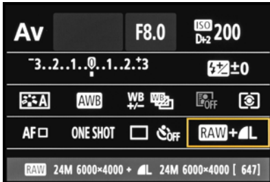
▲ Schnelleinstellungsbildschirm mit per Q/SET-Taste aufgerufener Bildqualität und per Hauptwahlrad geänderter Einstellung.
