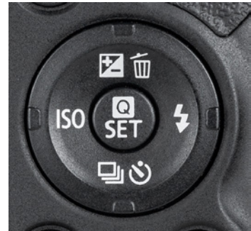
▲ Detailansicht der kreuzförmig um die Q/SET-Taste angeordneten Funktionstasten.
