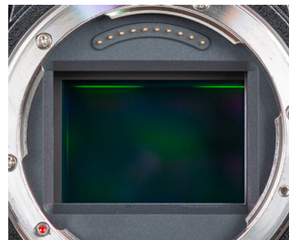
▲ Bei abgesetztem Objektiv ist der Sensor der S5II(X) zu sehen (35,6 mm × 23,8 mm, Vollformat, natives Seitenverhältnis 3:2).
