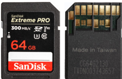
▲ SD-Karten mit UHS-II-Standard haben zwei Kontaktreihen und eine maximale Schreibgeschwindigkeit von 312 MB/Sek.
