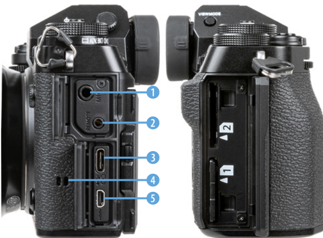
▲ Die Anschlussbuchsen der X-T5 auf der linken Kameraseite und die Steckplätze 1 und 2 für UHS-I oder UHS-II SD-Karten auf der rechten Seite.
