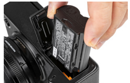
▲ Einlegen des Akkus vom Typ NP-W235 (7,2 V, 2200 mAh, 16 Wh).
