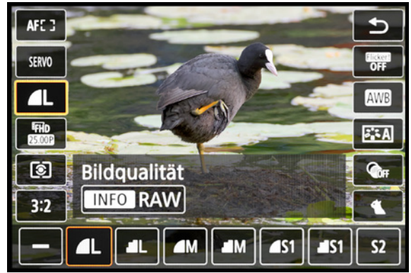
▲ Schnelleinstellung der Bildqualität mit der Option, das RAW-Format zuzuschalten und die Speicherkarte zu wählen.
