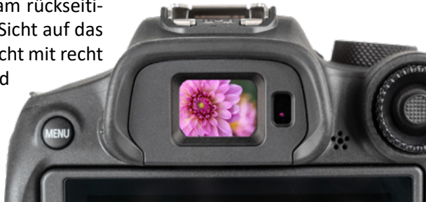
▲ Elektronischer OLED-Farbsucher mit 2,36 Millionen Bildpunkten (1.024 × 768 Pixel), 100 % Bildfeldabdeckung und einer Bild-diagonalen von 0,39 Zoll (knapp 1 cm).
