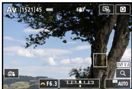
▲ Die optische Suchersimulation blendet die Belichtungs- und Farbeinstellungen aus und zeigt das Livebild in etwa so an, wie es optische Sucher früher getan haben.
