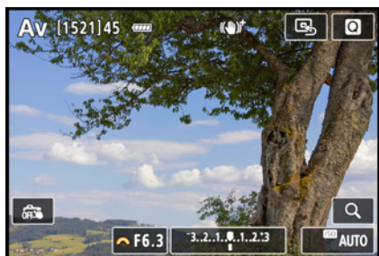
▲ Mit Belichtungssimulation und manueller Sucherhelligkeit entspricht das Livebild annähernd der fertigen Aufnahme.
