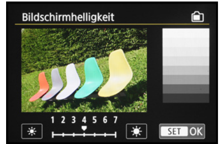
▲ Die eingeblendeten Graustufen sollten differenziert zu erkennen sein, sonst lässt sich die Belichtung nicht zuverlässig beurteilen.
