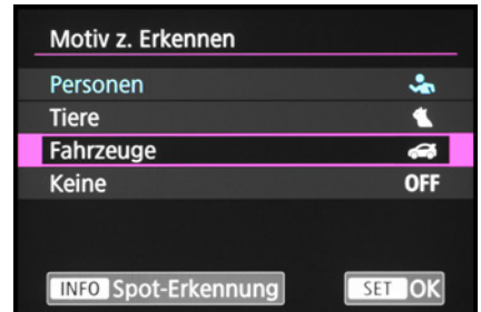
▲ Die benötigten Bedienungselemente werden eingeblendet, hier die INFO-Taste zum Ein- bzw. Ausschalten der Spot-Erkennung (Fahrzeugdetaillerkennung).
