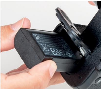
▲ Einlegen des Akkus in das Akkufach auf der Unterseite der GH6.
