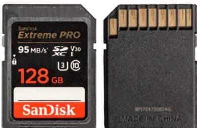
▲ SD-Karten des Standards UHS-I besitzen eine Reihe an Kontaktflächen. Die maximale Schreibgeschwindigkeit beträgt 104 MB/Sek.
