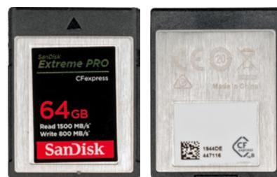
▲ Karten vom Typ CFexpress Typ B 2.0 liegen aktuell bei bis zu 1000 MB/Sek., die gezeigte liegt bei 800 MB/Sek. (Write).
