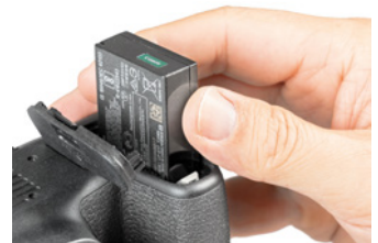
▲ In der EOS 800D werden Lithium-Ionen-Akkus vom Typ LP-E17 (7,2 V, 1040 mAh) verwendet.
