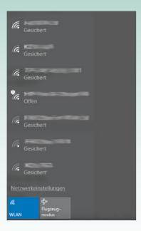
Beispiel auch Netzwerke Ihrer Nachbarn auftauchen. Wählen Sie durch Anklicken Ihr Netzwerk 1 aus (bei der Ersteinrichtung erkennen Sie dieses an der SSID) und klicken Sie anschließend auf die Schaltfläche *Verbinden* 2.
