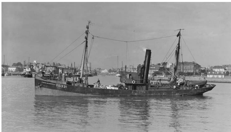
Abbildung 3: Der Seitentrawler PG 331 FRITZ SCHRÖDER war Baujahr 1921 und wurde erst 1951 verschrottet. Er hatte eine Länge von 38,95 Metern und ein Fassungsvermögen von 1900 Korb. Seine Besatzung umfasste 13 Mann. (Foto, um 1930, Archiv HMB)
