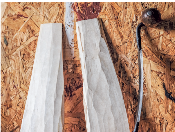
Zwei Werkstücke aus Espe zum Ornamentschnitzen, die mit einem Ziehmesser der Marke Arno abgeflacht wurden.
