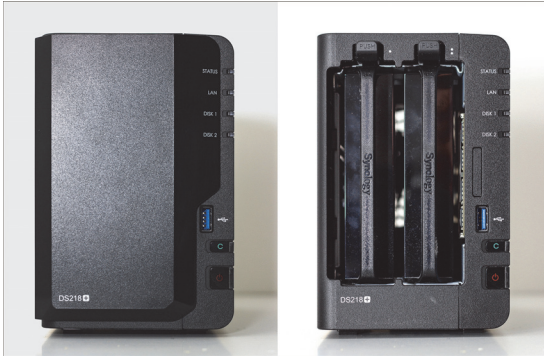
Abb. 2.1: Die Abdeckplatte kann einfach abgezogen werden, dahinter befinden sich die Einbauschächte.
