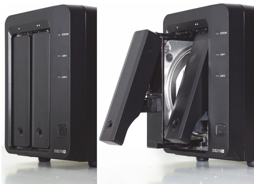
Abb. 2.7: Schieben Sie den Einbaurahmen ganz nach hinten, erst dann rastet die Griffblende richtig ein.
