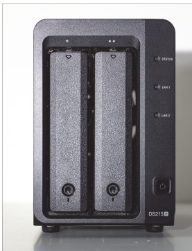
Abb. 2.2: Die Einbauschächte mit den Griffblenden
