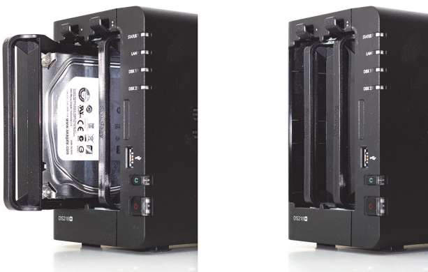
Abb. 2.6: Schieben Sie den Einbaurahmen so weit hinein, bis der Push-Knopf wieder einrastet.
