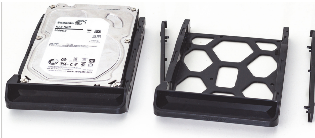
Abb. 2.4: Ein falsches Einbauen ist so gut wie nicht möglich.
