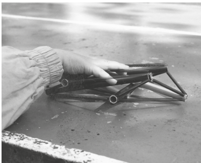
Wenn Sie ein Tensegritätsmodell zusammendrücken (a), springt es gleich wieder auseinander, sobald der Druck nachlässt (b).
