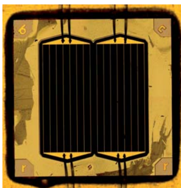
Metamorphe Tripelzelle mit einem Rekordwirkungsgrad von 41.1% auf Kupfersubstrat.
