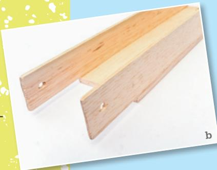
**3** An den äußeren Enden der Seitenwände, jeweils 2 cm vom Außenrand entfernt, bohrst du ein Loch,  $\varnothing$  5 mm. In diese Löcher kommen später die Achsen des Autos.
