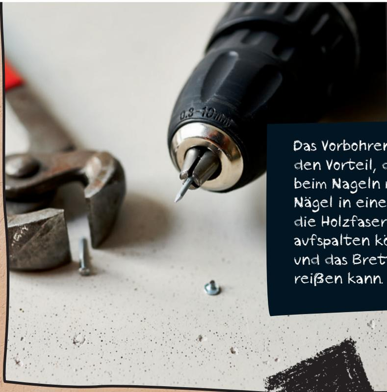
Das Vorbohren hat den Vorteil, dass sich beim Nageln mehrerer Nägel in einer Reihe die Holzfasern nicht aufspalten können und das Brett nicht reißen kann.
