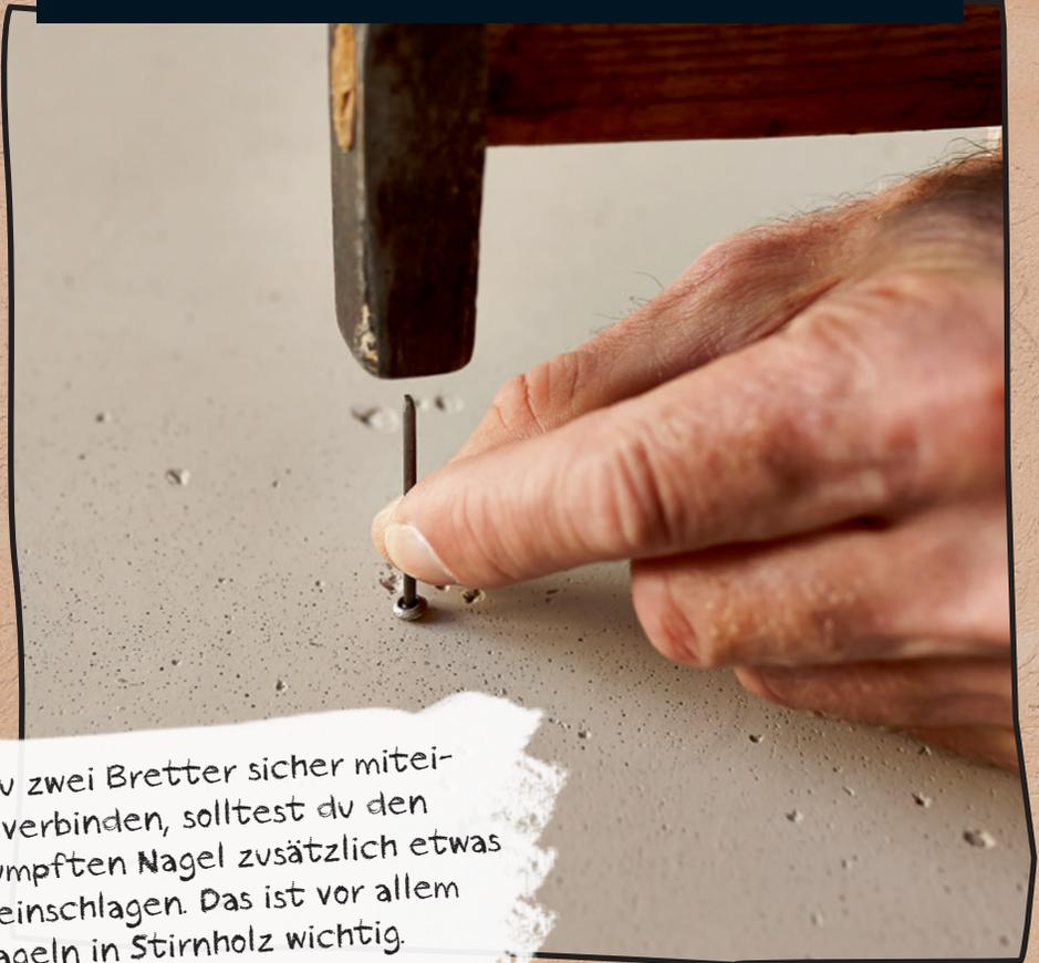
Willst du zwei Bretter sicher miteinander verbinden, solltest du den abgestumpften Nagel zusätzlich etwas schräg einschlagen. Das ist vor allem beim Nageln in Stirnholz wichtig.
