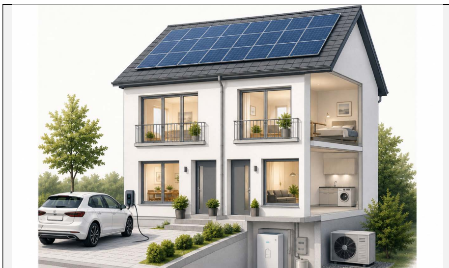
Abbildung 1: Einstiegsbild – Zweifamilienhaus mit Photovoltaik, Wärmepumpe, Batteriespeicher und Wallbox.
