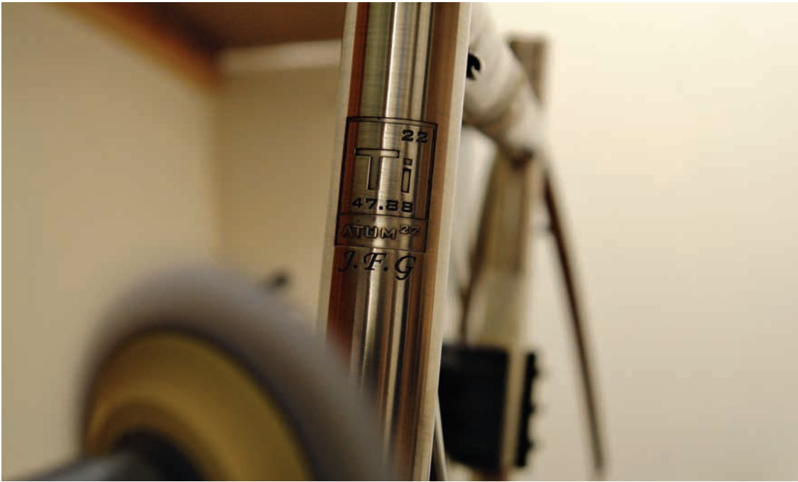
Hochglanzpolierte Rahmen benötigen bis zu drei Tage – die Initialen jedes Kunden werden ins Steuerrohr eingraviert.
