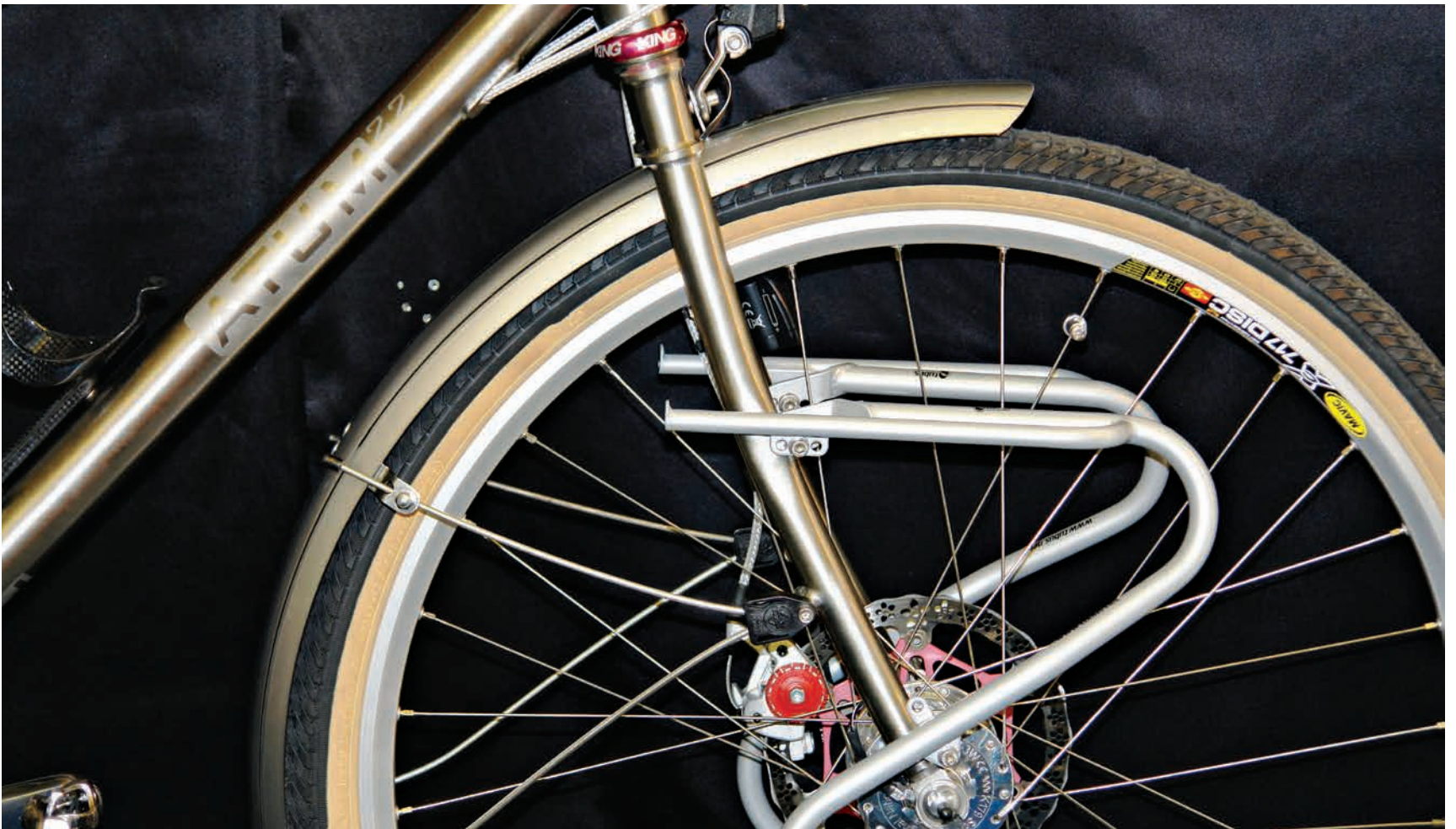
Nabendynamo mit Scheibenbremse und fortschrittlichem LED-Scheinwerfer.
