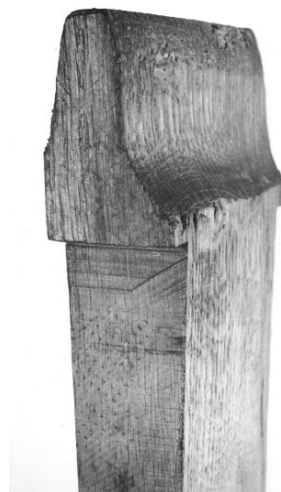
Bild 1/4 Verschlissener Holzzahn eines Göpelantriebes
