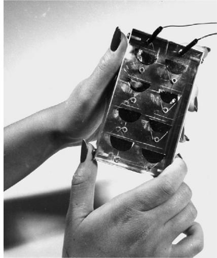
**Bild 1.12** Die Erfinder der ersten „echten“ Solarzelle: Chapin, Fuller und Pearson. Das rechte Bild zeigt das erste „Solarmodul“ der Welt, ein Minimodul aus 8 Solarzellen (Mit freundlicher Genehmigung des AT&T Archives and History Center)
