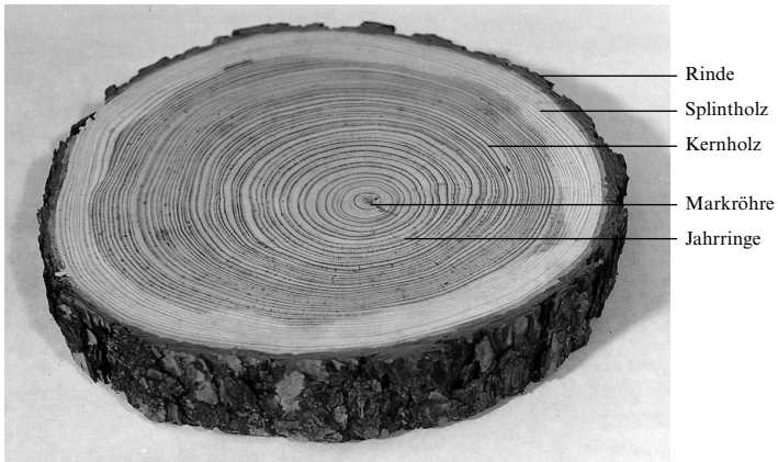
Bild 1.3: Stammquerschnitt von Lärche von außen nach innen: Rinde, Splintholz, Kernholz (Jahrringe deutlich)
