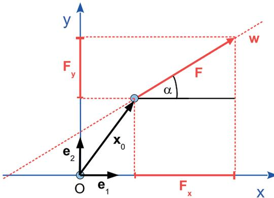
**Bild 2.11:** Kraftkomponenten in einem ebenen kartesischen Koordinatensystem
