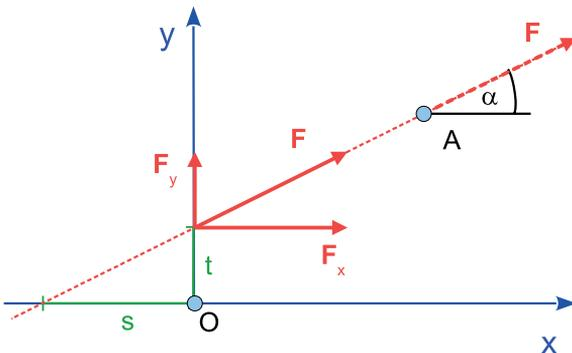
Bild 2.13: Drehmoment mit Achsenabschnitten
