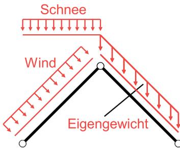
Bild 2.4: Typische Oberflächenkräfte
