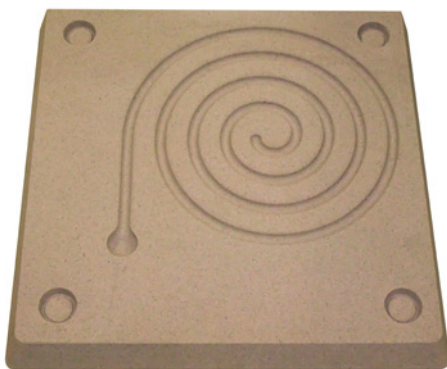
Abb. 1.29: Untere Formhälfte einer Gießspirale aus coldbox-gebundenem Sand
