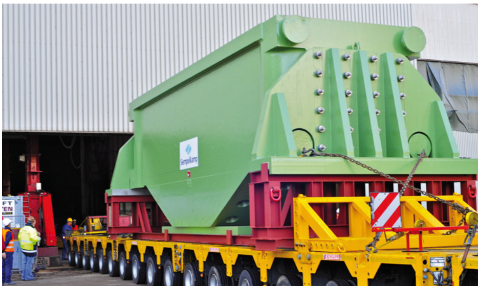
Abb. 1.5: Transport des 220 t schweren Oberholms (Quelle: Siempelkamp, Krefeld)
