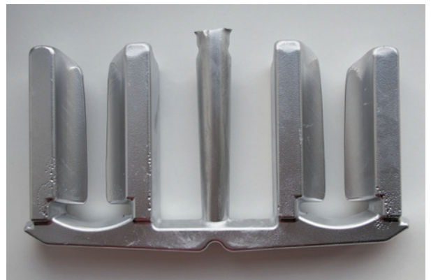
Abb. 1.25: Gussteil Bolzenprobe aus AISi7Mg0,3 in Anlehnung an (Engler, Ellerbok 1974)
