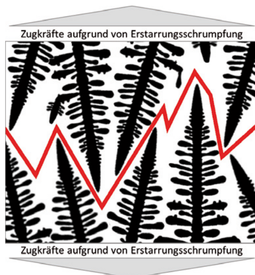
Abb. 1.38: Links: Bildung von Heißrissen schematisch: Aus der Erstarrungskontraktion resultierende Zugkräfte führen zur interdendritischen Trennung des Kristallverbandes (rot dargestellter Riss) und rechts: Stahlguss mit Warmrissen (schwarz) und ausgeheilten Rissen (weiß)
