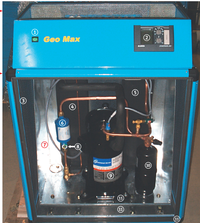
Bild 3.13: Kältetechnik einer Wärmepumpe
