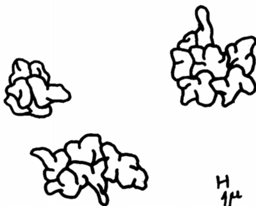
Abb. 11: Mikroskopisches Bild eines pulverförmig ausgeschiedenen Polymerisates
