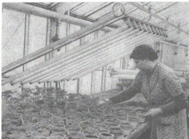
Abb. 2. Praxisaggregat PA 57 mit Schnapprollo als Reflektor. Kulturarbeiten können unter dem PA 57 sehr gut ausgeführt werden
