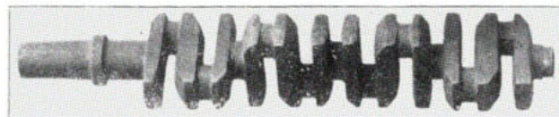
Bild 9. 5 mal gelagerte 8 Zyl.-Welle, geschmiedet.
