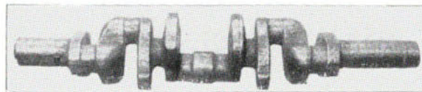
Bild 8. 4 mal gelagerte 6 Zyl.-Welle, geschmiedet.
