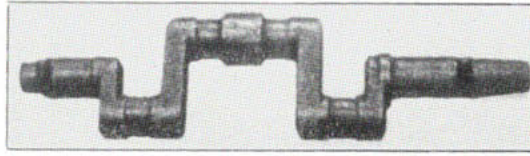
Bild 4. 2 mal gelagerte Welle, geschmiedet.
