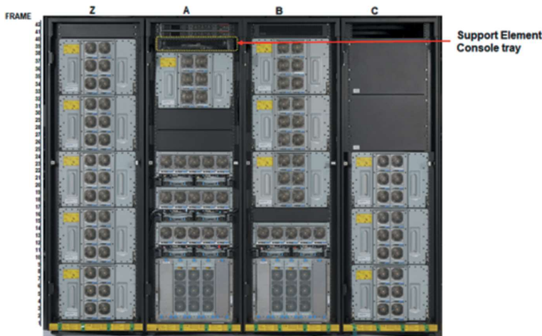
Abbildung 2.29: Vorderansicht des IBM Server z16 A10 (voll konfiguriert) mit Luftkühlung.
