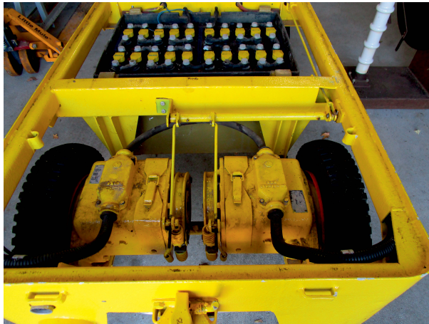
Abb. 2.8.: Bleiakкумуляtor (20 Zellen) und Motoren eines Elektrokarrens (Baujahr 1960), (Bildquelle: VDE Halle-Leipzig, Elektrotechnische Sammlung, Aufn. des Autors)
