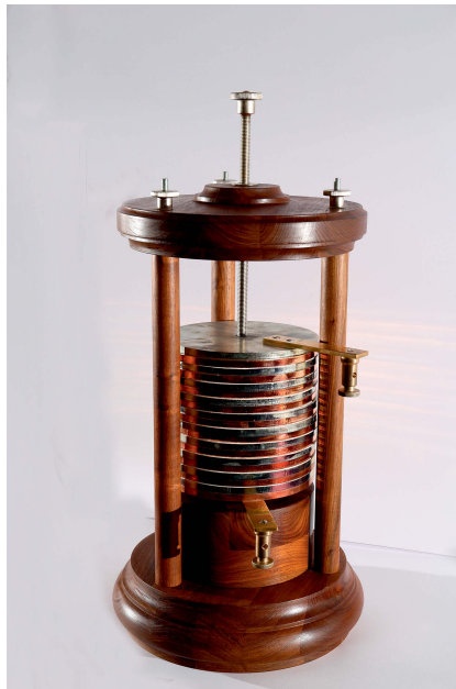
Abb. 2.1.: Modell einer voltaschen Säule (Bildquelle: Museums für Galvanotechnik, Leipzig)
