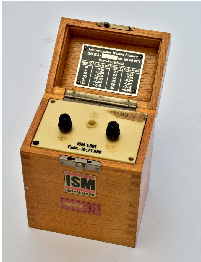
Abb. 2.10.: Internationales Weston-Element im Holzgehäuse mit Korrekturtabelle im Deckel (Bildquelle: TU Dresden, Physikalische Gerätesammlung)
