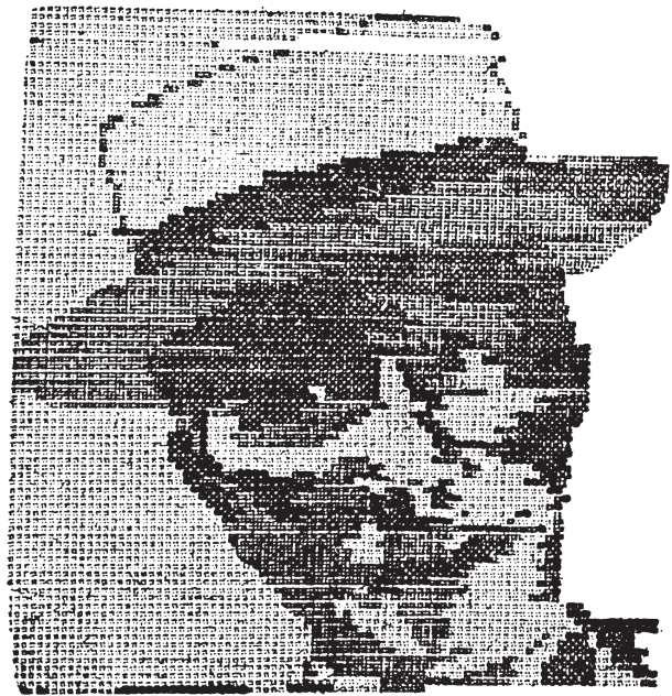
Abb. 3: Bildtelegrafische Übertragung des Porträts von John D. Rockefeller nach der statistischen Methode mit Hilfe einer Schreibmaschine, USA, 1910.
